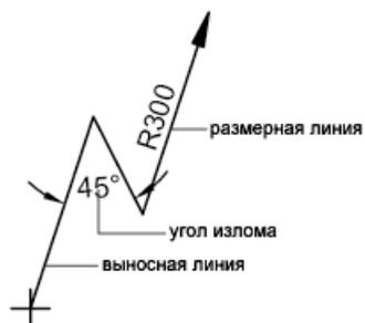
После создания размера радиуса с изломом его, а также положение центра можно изменять следующим образом:
