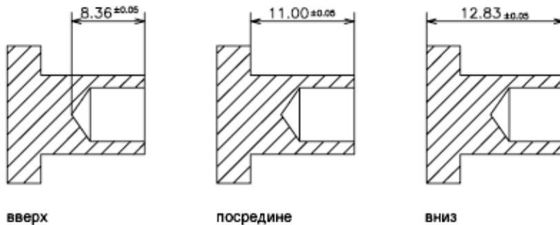
Помимо расположения значений допусков по вертикали, предусмотрена возможность выравнивания верхнего и нижнего значений допуска по горизонтали. Для выравнивания верхнего и нижнего значений допуска можно воспользоваться операционным символом или десятичным разделителем.
