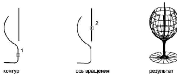
Контур называется криволинейной траекторией, которая может представлять собой любую комбинацию отрезков, кругов, дуг, эллипсов, эллиптических дуг, полилиний, сплайнов, замкнутых полилиний, многоугольников, замкнутых сплайнов или колец.
