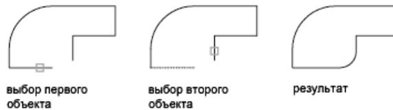
Внутренний угол называется сопряжением, а внешний угол - округлением; можно создать оба угла с помощью команды *СОПРЯЖЕНИЕ*.
