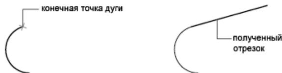
Аналогично, после построения отрезка можно приступить к построению дуги, касательной к отрезку в его конечной точке, для чего нужно вызвать команду *ДУГА* и нажать ENTER в ответ на запрос "Начальная точка". От пользователя в данном случае требуется только задать конечную точку дуги.
