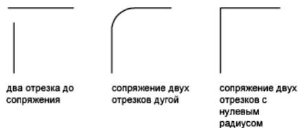
При выборе объектов для замены значения текущего радиуса сопряжения на 0 можно удерживать нажатой клавишу SHIFT.
