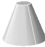
Для построения конического тела, определение сторон которого требует задания конкретного угла, начертите 2D круг, а затем с помощью команды *ВЫДАВИТЬ* и параметра "Угол конуса" задайте суживание к кругу, расположенному под углом к оси  $Z$ . Однако, этот метод обеспечивает построение выдавленного тела, а не подлинного примитива твердотельного конуса.
