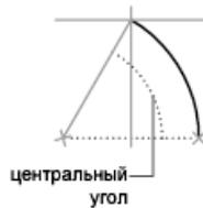
Положение конечной точки определяется центральным углом. Если же известны начало и конец, но неизвестен центр дуги, следует воспользоваться методом "Начало, конец, угол".
