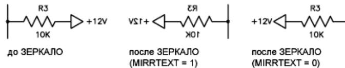
Переменная *MIRRTEXT* влияет на текст, который создан с помощью команд *ТЕКСТ*, *АТОПР* или *МТЕКСТ*, а также на описания атрибутов и переменные атрибуты. При зеркальном отражении блока текст и постоянные атрибуты, являющиеся частью вставленного блока, обращаются независимо от состояния параметра *MIRRTEXT*.
