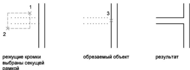
Один и тот же объект может быть одновременно и режущей кромкой, и обрезаемым объектом. Например, на чертеже осветительного прибора окружность является режущей кромкой для прямых линий, и в то же время обрезается сама.
