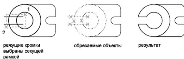
В следующем примере обрезаемые объекты выбираются с помощью линии выбора.
