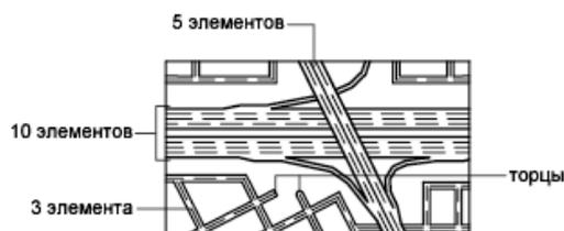
В стиле мультилиний может быть описано до 16 элементов. Элементы с положительным смещением располагаются по одну сторону от оси мультилинии, элементы с отрицательным смещением - по другую сторону.
