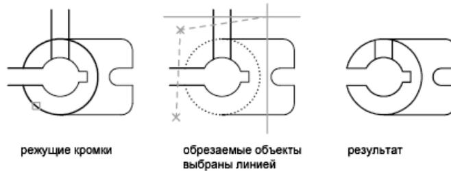
Имеется возможность обрезать объекты до их ближайших пересечений с другими объектами. Вместо указания режущей кромки следует просто нажать ENTER. Далее, после выбора обрезаемых объектов, ближайšie отображаемые объекты выступают в качестве режущих кромок. В следующем примере производится обрезка ненужных участков линий в месте пересечения стен.
