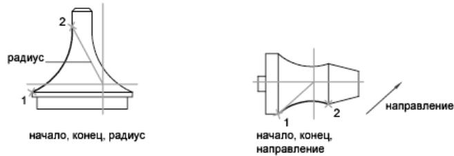
На чертеже справа изображена дуга, построенная с помощью устройства указания путем задания начальной и конечной точек и направления касательной. Если курсор перемещается вверх от начальной и конечной точек, то строится вогнутая дуга, как показано в данном случае. При перемещении курсора вниз строится выпуклая дуга.
