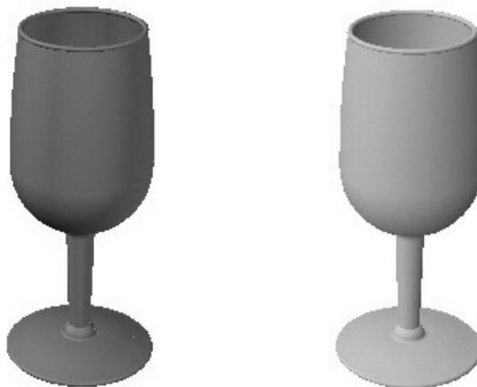
Когда активен стиль "Нет граней", отсутствует затенение и отображаются только кромки граней.
