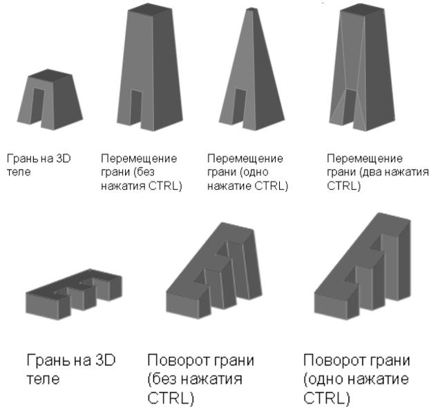
При выполнении переноса, поворота или масштабирования грани без использования клавиши CTRL грань изменяется вместе со своими ребрами, сохраняя свою форму и ребра, но при этом возможно изменение плоскостей плоских граней, смежных с изменяемой.
