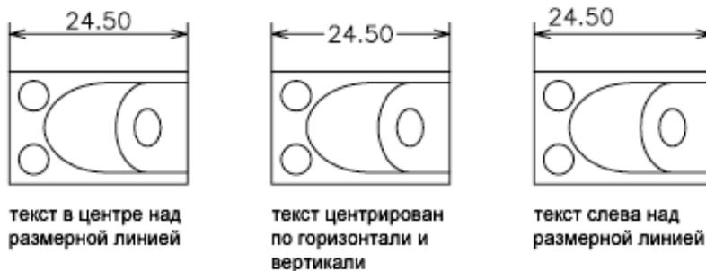
Многие параметры размещения взаимосвязаны. В Диспетчере размерных стилей выводится пример изображения, обновляемый каждый раз при смене параметров для показа результата размещения размерного текста.
