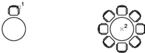
При генерации массива радиус определяется расстоянием от центра массива до опорной или базовой точки на последнем выбранном объекте. Для создания массива может использоваться текущая опорная точка, обычной совпадающая с точкой привязки, или новая указанная базовая точка, которая в дальнейшем используется в качестве опорной точки.
