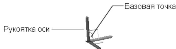
Далее следует свободно перемещать объекты путем перетаскивания инструмента ручки к наружной стороне или обозначить ось или плоскость, которой ограничивается перемещение.
