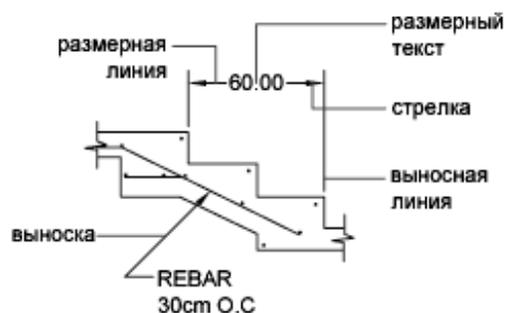
*Размерный текст* указывает величину размера. Размерный текст может включать в себя различные специальные обозначения в виде префиксов и суффиксов, а также допуски.
