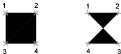
Следует учитывать, что для создания четырехугольника верхняя и нижняя стороны должны определяться в одном направлении. При задании следующих пар вершин необходимо придерживаться установленного порядка указания для получения ожидаемого результата.
